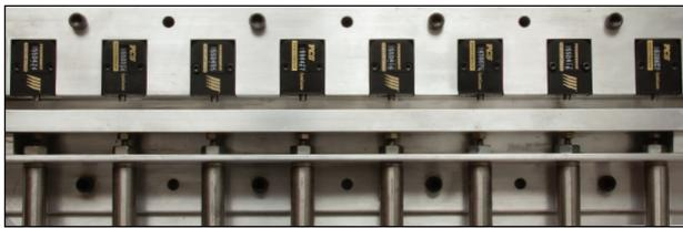
用独立测试设备进行耐久性测试确定各种模具计数器的故障点，进入网站[www.procomps.com/CounterView](http://www.procomps.com/CounterView)。查看测试数据和录像。
