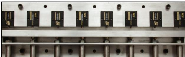
Las pruebas de resistencia se llevaron a cabo a través de un centro de pruebas independiente para determinar el punto de fracaso de los diversos contadores de molde. Para ver datos de la prueba, videos y mucho más visite [www.procomps.com/CounterView](http://www.procomps.com/CounterView).
